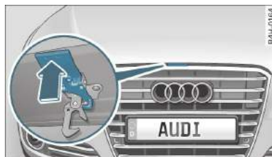
Rys. 183 Przetącznik pod pokrywą przedziału silnikowego ►
