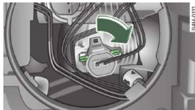
Rys. 231 Wtyczka żarówki: Zaczepy prowadzące
