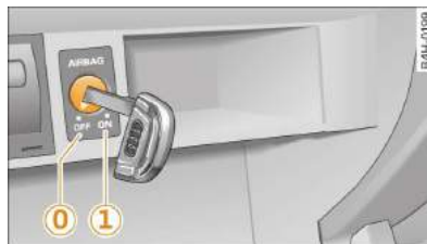
Rys. 164 Przedni schowek: Wyłącznik na kluczyk do wyłączenia poduszki przedniego pasażera
