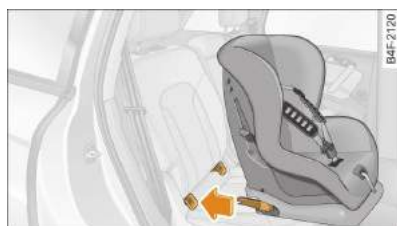
Rys. 171 Tylne siedzenia: przymocowanie fotelika z systemem ISOFIX
