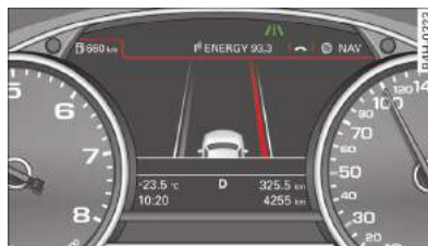
Rys. 109 Wyświetlacz: system lane assist włączony i ostrzega
