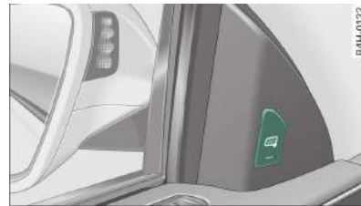
Rys. 113 Drzwi kierowcy: przycisk systemu side assist
