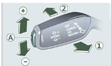
Rys. 89 Dźwignia: Układ utrzymywania prędkości
