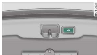
Rys. 26 Przycisk zamykania w pokrywie bagażnika
