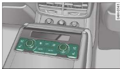
Rys. 77 Komfortowy układ klimatyzacji 4-strefowy*: elementy obsługi z tyłu
