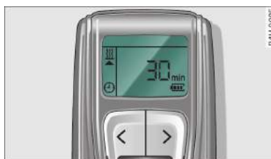
Rys. 81 Zdalne sterowanie dla ogrzewania postojowego: natychmiastowe załączenie
