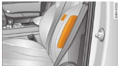
Rys. 160 Miejsce zamontowania poduszki bocznej w siedzeniu kierowcy
