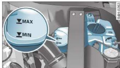
Rys. 187 Przedział silnikowy: oznaczenia na zbiorniku wyrównawczym płynu chłodzącego
