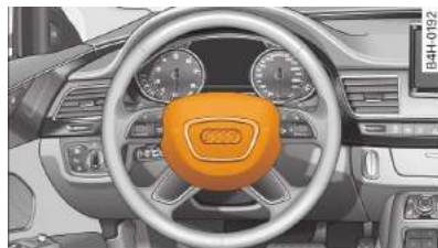
Rys. 156 Kierownica: poduszką bezpieczeństwa kierowcy
