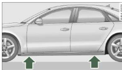
Rys. 208 Zmiana koła: punkty podparcia podnośnika
