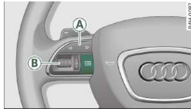
Rys. 5 Kierownica wielofunkcyjna: obsługa systemu informowania kierowcy
