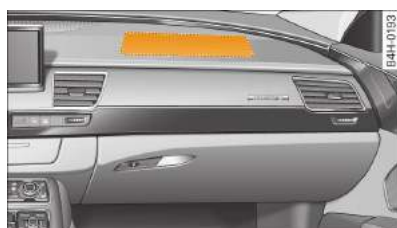
Rys. 157 Tablica przyrządów: Poduszka bezpieczeństwa przedniego pasażera
