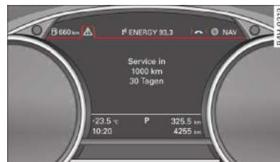
Rys. 10 Wyświetlacz w zestawie wskaźników: wskazanie terminów przeglądu
