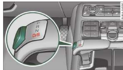
Rys. 92 Dźwignia przelatczania zakresów ►
