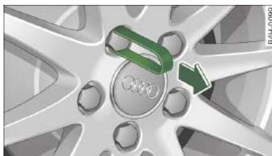
Rys. 206 Zmiana koła: zdejmowanie osłon śrub
