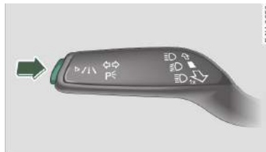
Rys. 107 Dźwignia kierunkowskazów: przycisk dla lane assist
