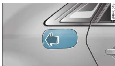
Rys. 179 Samochód z tyłu, z prawej strony: otwieranie pokrywy wlewu paliwa
