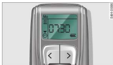
Rys. 82 Zdalne sterowanie dla ogrzewania postojowego: Nastawianie timera
