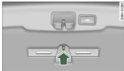
Rys. 195 Pokrywa bagażnika: trójkąt ostrzegawczy
