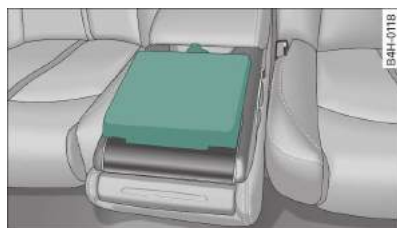
Rys. 72 Środkowy podłokietnik z tyłu: zakładanie osłony zabezpieczającej
