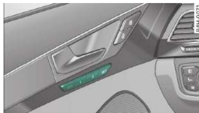
Rys. 57 Drzwi kierowcy: przyciski funkcji pamięci
