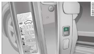
Rys. 22 Przednia część drzwi kierowcy: przycisk systemu kontroli wnętrza/zabezpieczenia przy holowaniu
