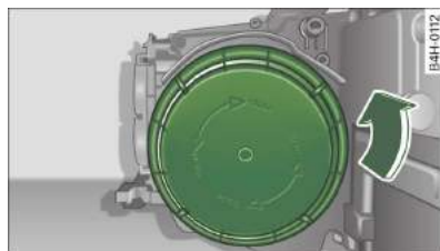
Rys. 226 Główny reflektor: zdejmowanie pokrywy
