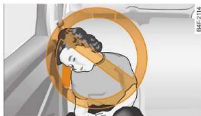
Rys. 166 Przykładowy rysunek niebezpiecznej pozycji siedzącej w strefie działania bocznej poduszki bezpieczeństwa
