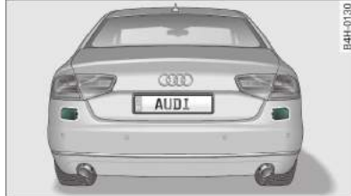
Rys. 111 Tylny zderzak: położenie czujników radarowych (z zewnątrz niewidoczne)
