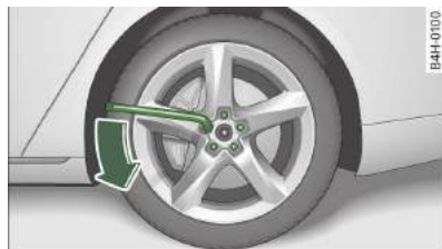
Rys. 207 Zmiana koła: luzowanie śrub koła
