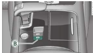
Rys. 88 Fragment konsoli środkowej: przycisk asystenta ruszania
