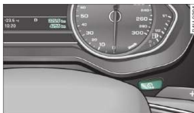
Rys. 7 Zestaw wskaźników: licznik kilometrów i przycisk zerowania
