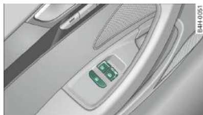
Rys. 46 Tyłne drzwi: przyciski żaluzji słonecznej
