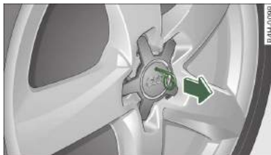
Rys. 205 Zmiana koła: zdejmowanie osłony piasty
