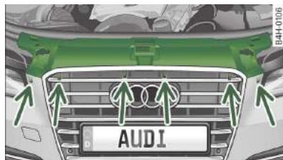
Rys. 224 Przedział silnikowy: zaślepka i mocowania
