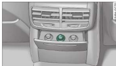
Rys. 62 Przykład konsoli środkowej z tyłu: zapalniczka
