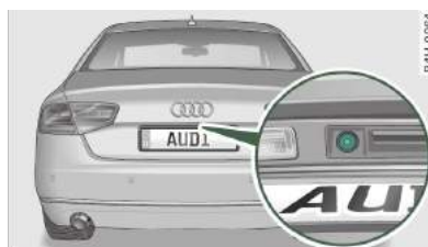
Rys. 134 Pokrywa bagażnika: usytuowanie kamery wstecznej
