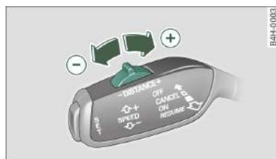
Rys. 105 Dźwignia: Nastawianie odstępu
