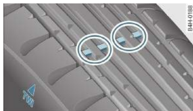
Rys. 192 Profil opony: wskaźnik zużycia
