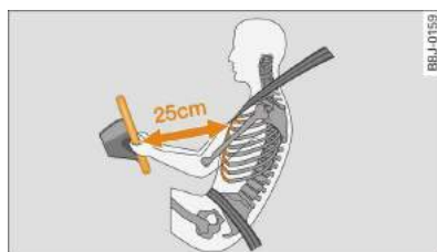
Rys. 141 Minimalny odstęp kierowcy od koka kierownicy
