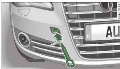
Rys. 216 Przedni zderzak: wkręcanie ucha holowniczego
