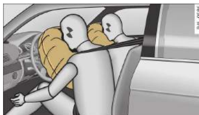
Rys. 158 Napętnione przednie poduszki bezpieczeństwa
