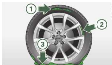
Rys. 202 Uszkodzenia opon, dla których zestaw naprawczy nie jest przeznaczony
