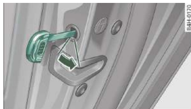
Rys. 28 Blokada otwarcia od wewnątrz, w tylnych drzwiach
