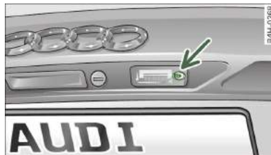
Rys. 233 Wbudowana lampka tablicy rejestracyjnej: śruba
